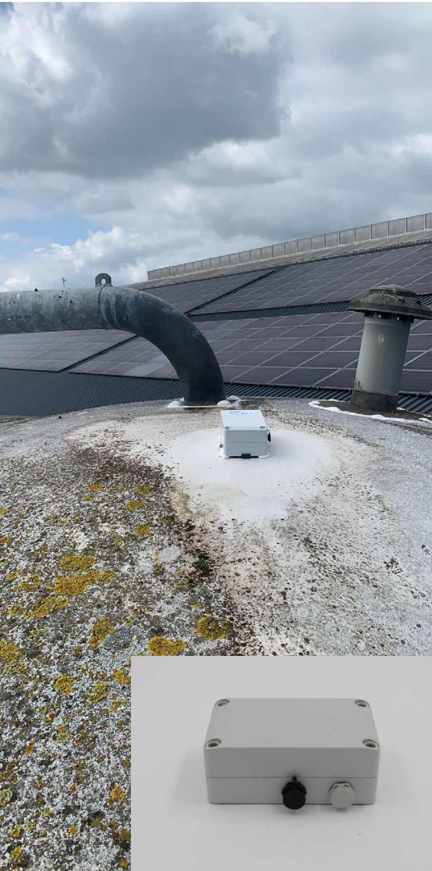
Prototyp des Füllgradsensors an einem Silo befestigt Eind-prototype/model radar vulgraadsensorboven op voersilo bevestigd
